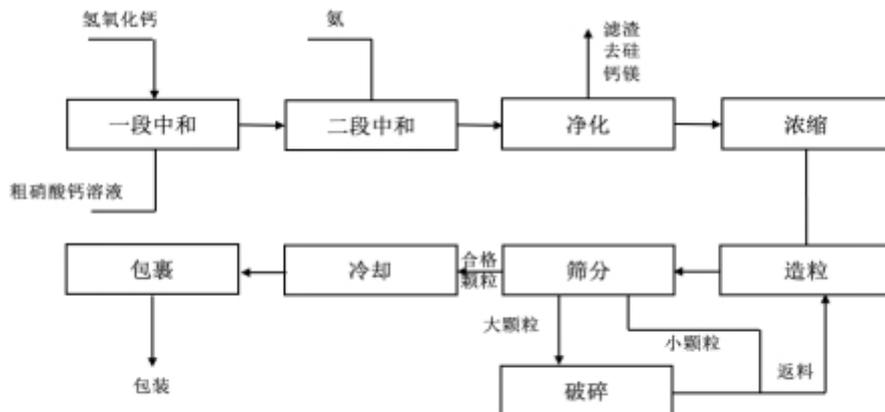
(4) 高塔造粒复合肥工艺流程
