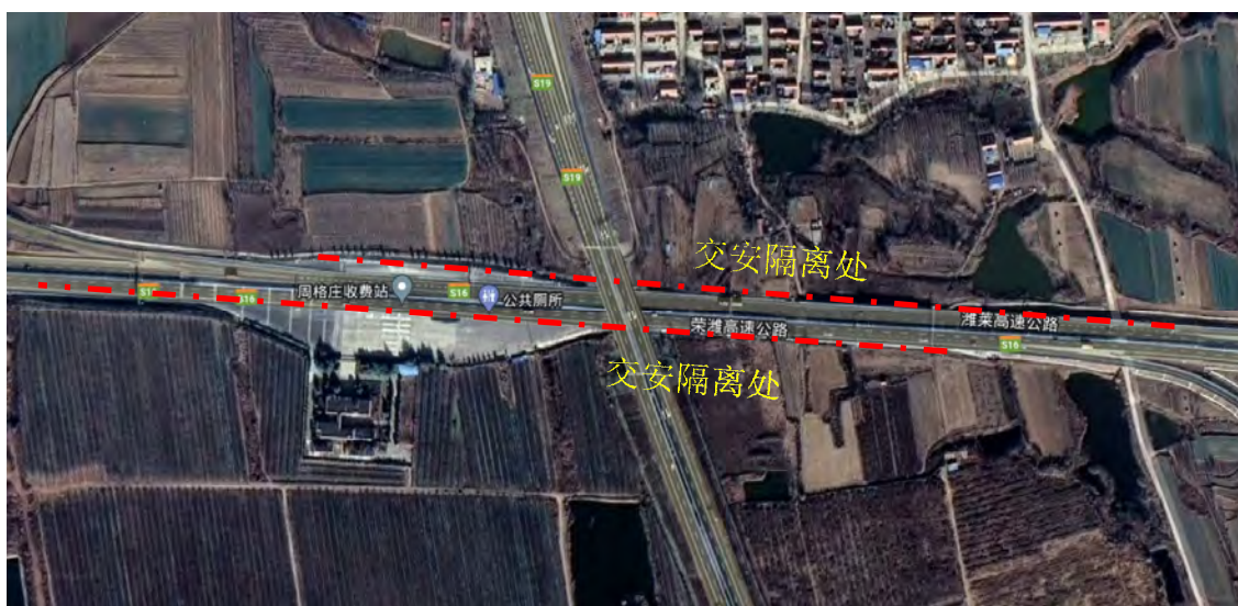
图 莱西北-冯格庄互通立交主线与匝道车流隔离处理
