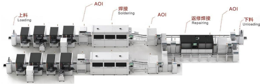
图：零缺陷焊接检测制造系统示意图
