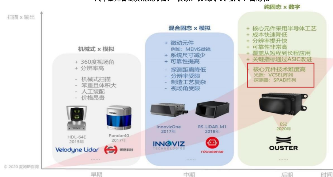
汽车激光雷达发展线路图：“模拟、机械式”到“数字、固态化”
