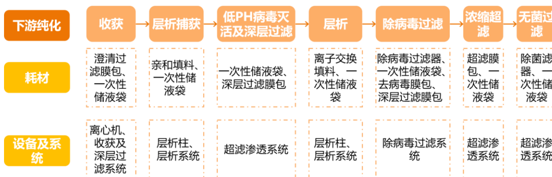
生物药分离纯化流程示意图
