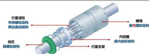
行星滚柱丝杠及相关构造拆解
