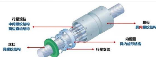
行星滚柱丝杠及相关构造拆解
