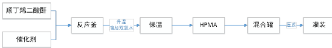
(5) AA/AMPS (2-甲基-2-丙烯酰胺基丙磺酸类共聚物) 生产流程图:
