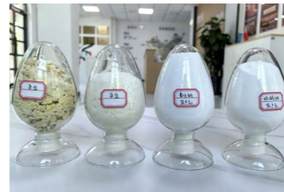
高盐废水零排放项目资源化副产品
