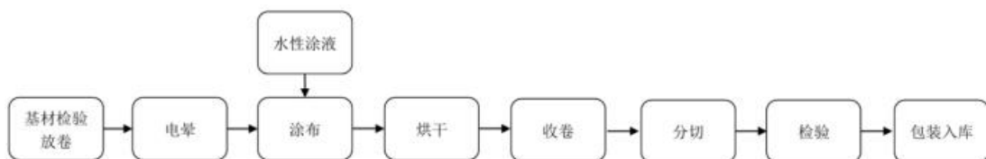
图：广告喷墨打印材料主要工艺流程（无需背胶）
