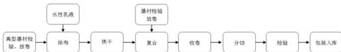
图：广告喷墨打印材料主要工艺流程（无需涂层）
