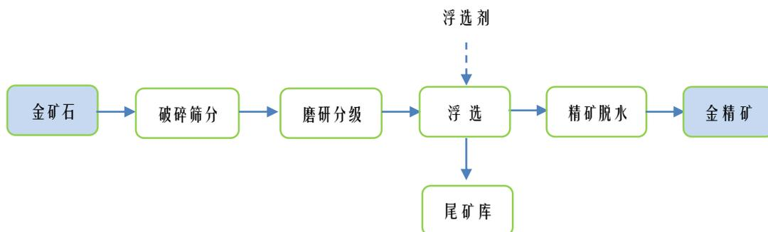
破碎筛分采用“二段一闭路”工艺流程；磨矿采用“一段磨矿两段分级”工艺流程，最终磨矿细度为-200 目；浮选采用“一优一粗二扫一精”工艺流程，浮选精矿送至浓缩机浓缩；精矿脱水采用“浓缩+过滤”两段脱水工艺；浮选尾矿送至采空区充填或尾矿库堆存。
