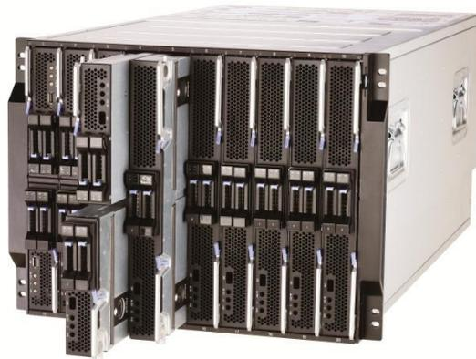
图：刀片式 ARM 服务器
