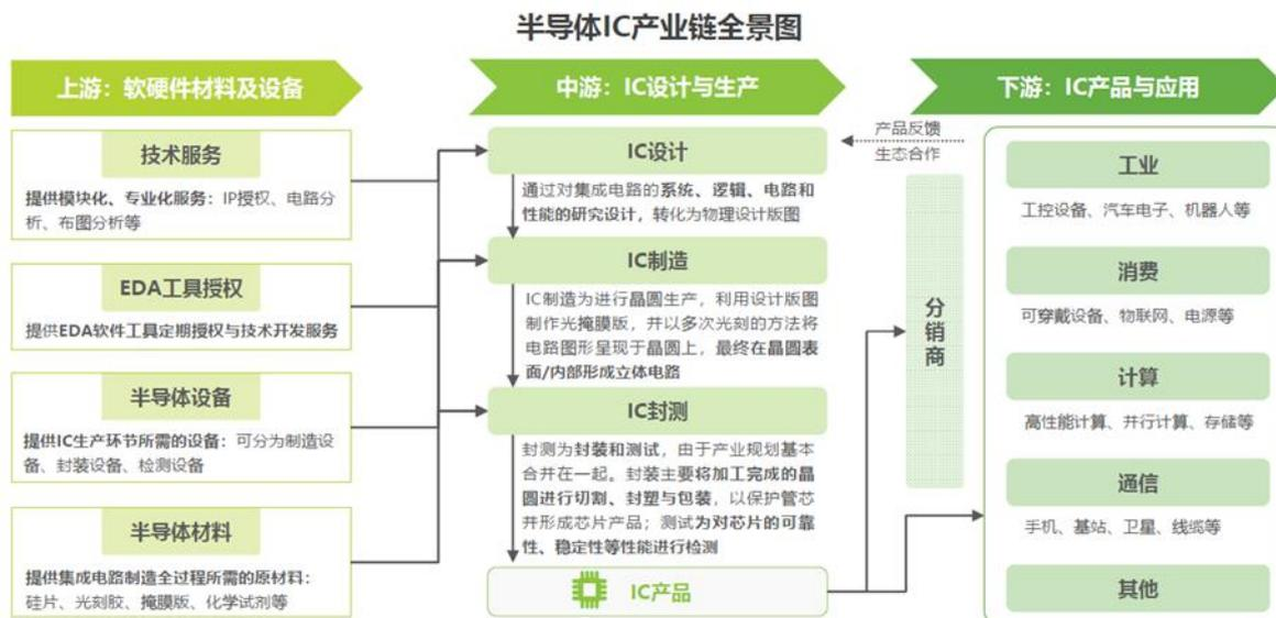
在 IC 设计环节, 公司隶属的数字电路主要可分为存储电路、逻辑电路与微型集成电路三大类。其中, 逻辑电路按照通用性可分为 CPU、GPU-通用芯片、FPGA-半定制化芯片与 ASIC-定制化芯片, 微型集成电路由 CPU 中央处理器的微型趋势演变发展而来, 可分为 MCU 微控制器单元、MPU 微处理器单元、DSP 数字信号处理、SoC 芯片 (系统级芯片) 等产品。公司产品属于 SoC 芯片 (系统级芯片), 可应用于智能音频、智能穿戴、智能家居等 AIoT 领域。
