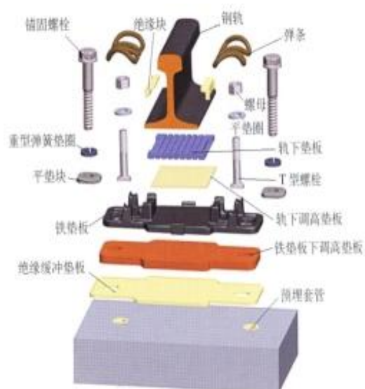
WJ-7型扣件组装零件图
