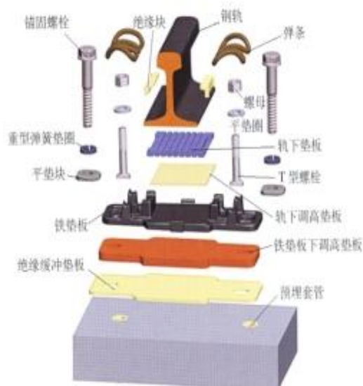
WJ-7型扣件组装零件图
