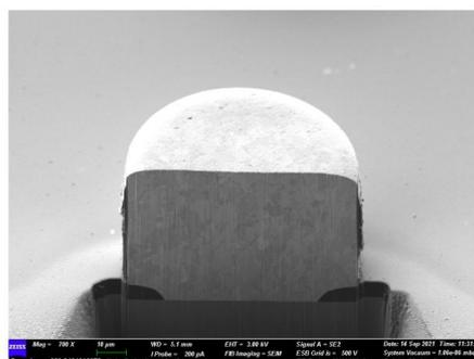
铜柱沉积电流：6ASD（5 μm）
