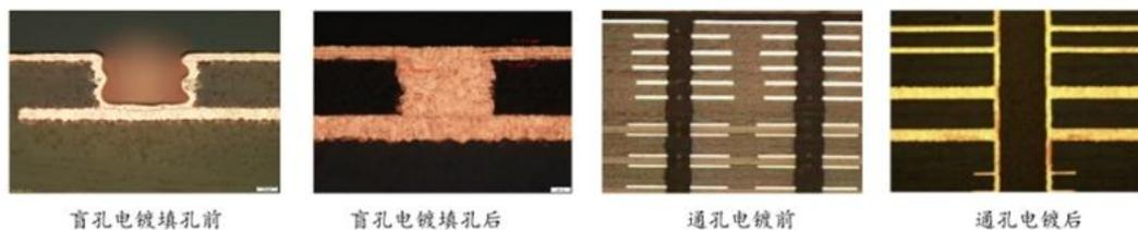
随着电子产业发展，高端印制线路板的孔纵横比越来越大，线宽线距变得越来越小，对电镀铜工艺的挑战也越来越高。随着线宽线距变得越来越小，传统电镀工艺使用的可溶性阳极在电镀过程中会因为溶解消耗导致尺寸形状发生变化，影响电流分布，进而影响铜镀层在电路板表面上的均匀性；随着通孔厚径比的增大，电镀工艺的深镀能力也需要进一步提升。
