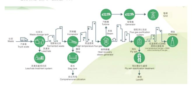
垃圾焚燒發電系統的核心設備是焚燒爐,公司主要使用自主研發的三驅動逆推式爐排爐,該種焚燒爐具有獨特的一體式三段設計,乾燥、燃燒、燃燼段均配置獨立驅動機構,可靈活根據燃燒工況調整各段的運行速度,以 更好地控制火床分佈,使得灰渣熱灼減率更低。
