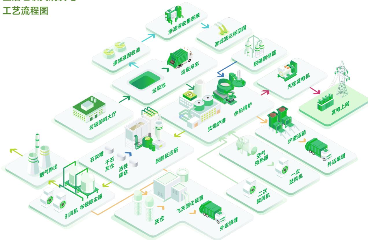
— 垃圾预处理流程 — 灰渣流程 — 蒸汽流程 — 烟气流程 — 供风流程 — 渗滤液处理流程
