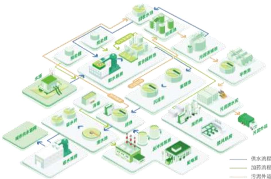
图 1：供水处理工艺流程介绍图示
