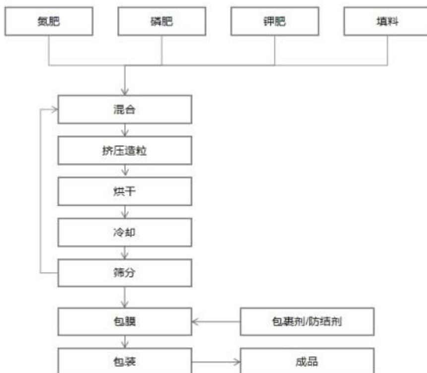
4、转鼓复合肥生产工艺流程说明：转鼓工艺制备复合肥的主要原料尿素、硝磷复肥、磷肥、钾肥，经计量的尿素或
