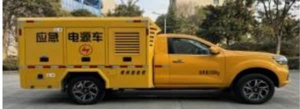
100kW 小型化应急电源车
