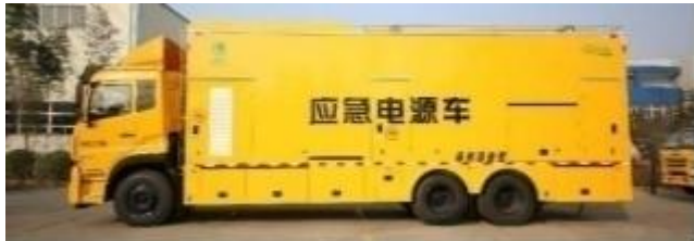
混合 UPS 不间断电源车
