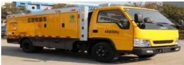
200kW 小型化应急电源车
