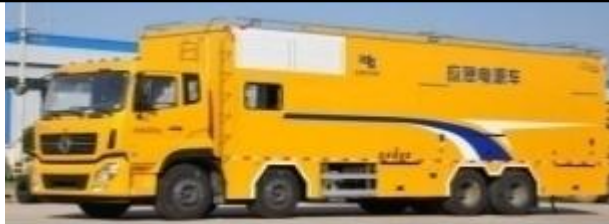
1000kW 中压应急电源车
