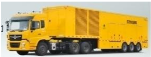
1600kW/10kV 中压电源车
