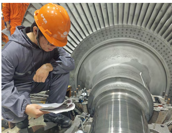
肇庆电厂 1 号机 A 修中压缸回装汽机专业人员测量转子轴跳动
