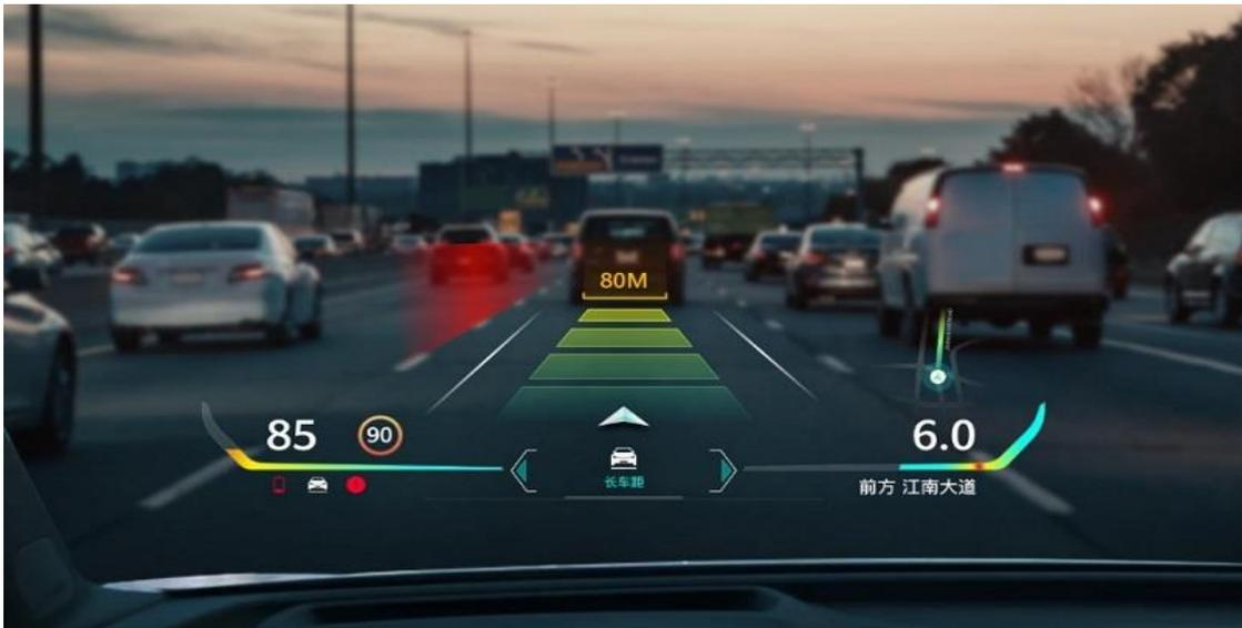
公司还提供对赋能 HUD 应用至关重要的 LCOS 产品。HUD 通过将信息直接投影至用户的视野内，通常是在透明及反光的表面上，为便利驾驶员操作及驾驶安全提供更强支持。在汽车 AR-HUD 的应用方案上，LCOS 作为反射式投影技术，与目前主要应用的 DLP 方案相比有着更好的透光率及更高的耐热性，能保证更好的性能从而也能更好的保护驾驶员的安
