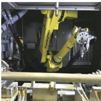
机器人手持式水锤脉冲喷嘴
