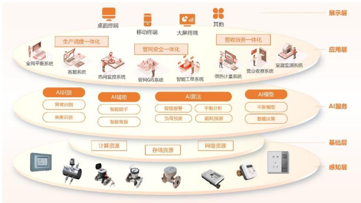
DeepSeek、百度文心、阿里通义在内的多种国内领先大语言模型，根据供热领域多年经验，构建覆盖行业全链条的知识图谱，涵盖多模态数据，将分散的海量数据进行集中化、智能化管理，实现知供热识动态关联与推理，为热力提供精准决策依据。其中具有代表性的是公司针对供热系统“近端过热、远端不热”的行业痛点，研发动态末端平衡调节系统，通过部署物联网智能调节阀与室温采集器，结合大模型算法实时优化全网热力分配。
