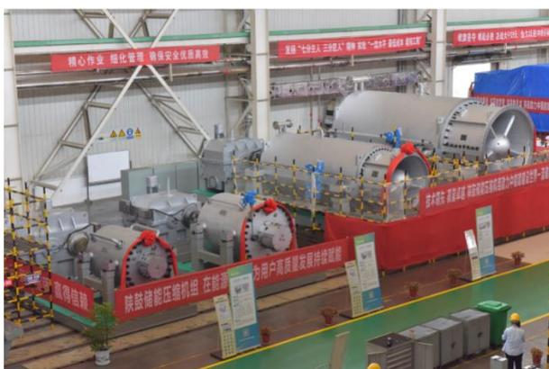
**装备技术国际领先，持续扩大压气储能装备技术领先优势。**公司支持中国新能源和新型电力系统的新型储能市场，持续开展压气储能技术研发与提升，将世界一流的储能技术与获得中国工业大奖的能源互联岛技术结合，具备了从中温到高温、从小型 10MW 到大型 660MW 不同工况要求压气储能核心设备设计制造能力，并在市场上全面推广应用，实现了压气储能领域大中小规模的全覆盖。世界首台（套）300MW 级压气储能电站大型压缩机组一次试车成功，顺利并网，该储能项目采用全球首创、全绿色、非补燃、高效率的 300MW 级压气储能技术，创造了 6 个行业示范、数十项国际首创、全球首次突破。
