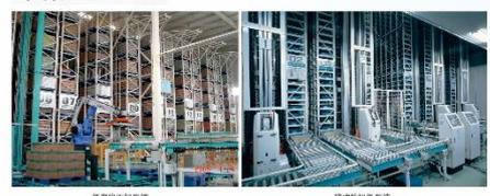
托盘堆垛机系统      悬吊堆垛机系统
