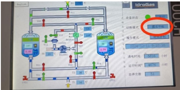
干燥机露点节能模式
