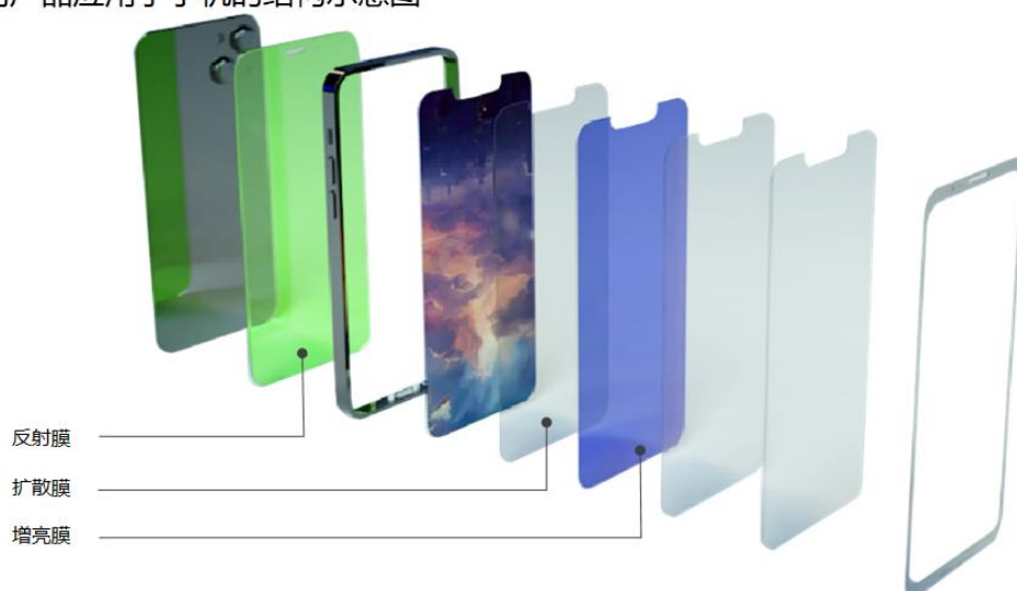
公司产品应用于手机的结构示意图
