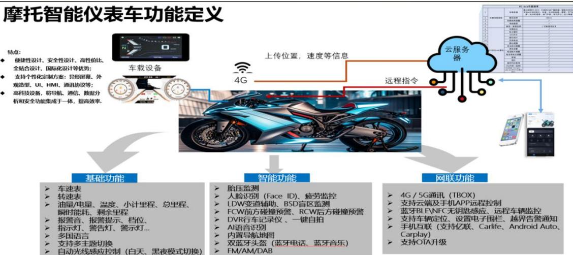
智能仪表（TFT 屏显示模组）是集成于机车的智能化控制和显示平台，连接机车、手机和车辆服务系统云端。智能仪表终端可以通过车辆控制区域网络系统收集车辆各装置的状况，如速度、胎压、油量、电量等，通过将相关信息集成显示至智能仪表，驾驶者能一目了然获取行驶数据，对突发状况进行及时反应，显著提升驾驶乐趣及驾驶安全性。研发部门通过传感器数据处理算法、显示控制算法、通讯协议算法、故障诊断与报警算法、节能与效率优化算法等行业关键算法，实现了对摩托车、电动车运行状态的实时监控、数据采集、处理和分析。通过仪表获取车身 ECU 进气量和转速，扭矩和喷油相关数据，绘制动态曲线，匹配发动机最佳动力输出，降低油耗和实时提醒空滤器保养，可增强驾驶体验。同时驾驶者可以通过手机蓝牙与机车连接，将手机资讯如导航、路况等投射于智能仪表显示屏上，获取安全、便捷、友善的骑乘体验。
