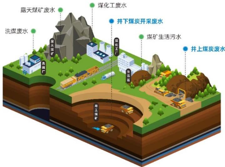
公司基于分级处理和分质回用理念，针对煤炭开采废水高浊、高盐等处理痛点，自主研发矿井水处理与回用技术产品集群，攻克传统工艺流程冗余、膜污染严重、能耗高和碳排放量大等共性难题。依托井下原位超磁分离水体净化设备、煤泥水重介质回收设备、磁沉淀快速除硬一体化设备和浓缩过滤离心机等核心设备，构建井下原位处理与回用、井下/井上深度处理与回用、井下/井上零排放处理与回用三条工艺路线，实现污染物去除与资源回收的双突破。公司已建立覆盖地面、井下、露天及应急等多场景的矿井水处理服务能力，通过工艺包定制、装备集群化供应及运营管理三位一体的业务架构，持续推动煤炭矿井水治理向低碳化、资源化、装备化方向升级迭代。近年来，公司已为国内 40 余家煤业集团提供 200 余项服务，代表性项目包括扎鲁特旗扎哈淖尔煤业疏干水处理项目、陕西红柳林煤矿矿井水处理项目、济宁能源高盐水资源化利用 BOT 项目以及陕西中太能源朱家崕煤矿矿井水零排放处理项目等。
