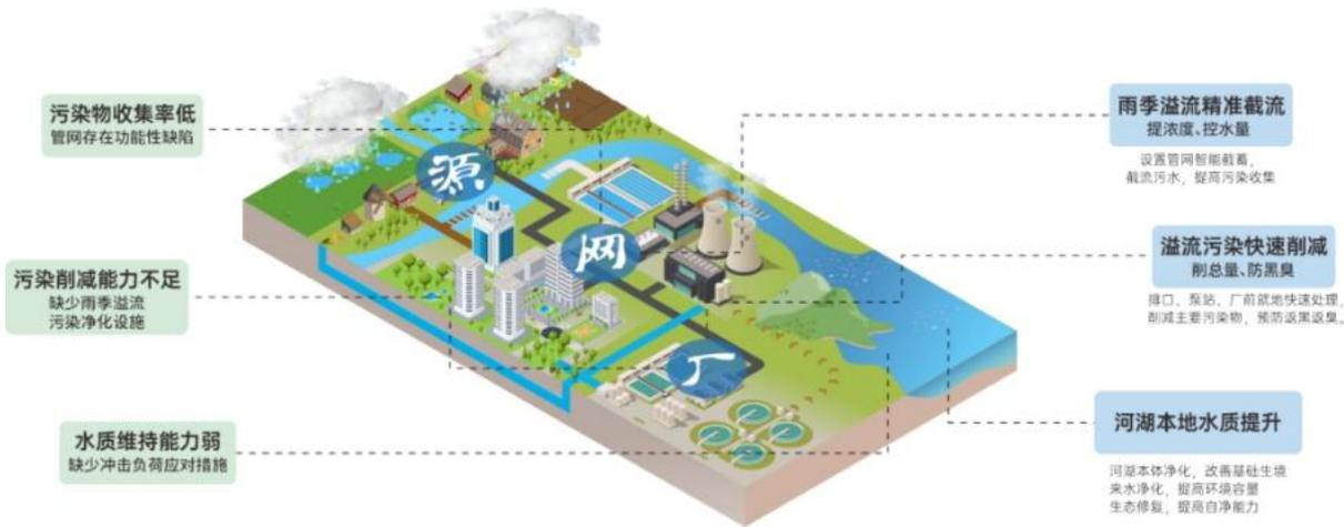
公司面向“厂网河湖整体网联”场景，依托自主知识产权技术，破解水环境治理系统性难题。针对管网污染物收集效率瓶颈，开发智能截流调蓄系统，实现污染物的精准收集与动态调控；针对河湖溢流污染问题，通过磁分离快速净化技术构建集约高效的模块化处理单元，突破传统污水厂处理能力的刚性约束，有效应对溢流污染冲击；在河湖水质提升方面，整合超磁分离净化与生态修复技术，创新打造“超磁水体净化+生态韧性修复”解决方案，形成从水质提升到生态重构的技术闭环。目前，公司已构建覆盖“源头污染精准收集、溢流污染高效削减、河湖水质与生态提升”完整产品体系，形成“诊断-治理-运维”全生命周期服务，持续推动水环境治理向智慧化、系统化、生态化升级。典型案例包括嘉兴南湖、九水水环境生态修复项目，武汉黄孝河、机场河分散处理项目，合肥瑶海南淝河初期雨水截流调蓄项目，茅箭区泗河初期雨水治理项目等。
