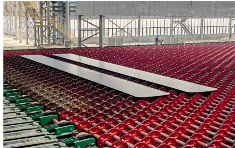
2024 年 2 月，中钢设备 EPC 总包建设的铜陵景钢 3500mm 中厚板项目投产，采用中钢设备具有自主知识产权的、全线的自动化控制软件和模型包，其超高水平的智能控制系统、自动控制系统硬件、系统软件及现场总线技术代表当今中厚板生产线最先进的自动化技术及未来的发展方向。
