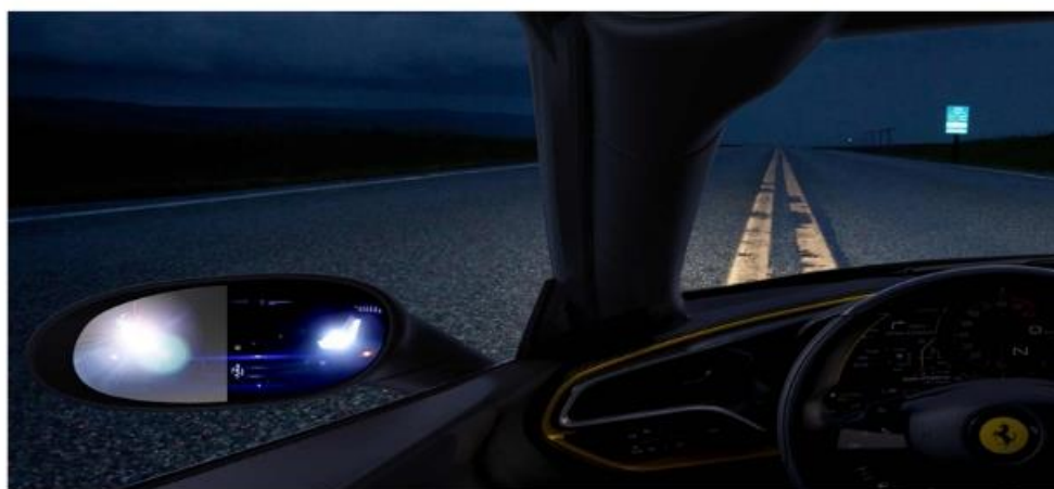
该后视镜左半部分为反光镜效果，右半部分为 EC 镜效果，EC 镜可根据投射到其上的光线亮度迅速自动变暗，能够为驾驶员有效地减少反射眩光。
