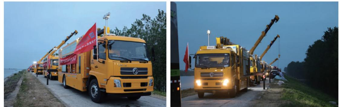
在湖南省应急管理厅的统一指挥下，盈峰环境救援队精准定位至决口周边关键排涝点进行作业。13台盈峰环境大流量排水抢险车共同发力，每小时排水量达65000立方米，如同一条条“巨龙”，不断吞噬着垸内的积水，有效减轻了内涝压力。另外，盈峰环境大流量排水抢险车配备了超长臂架，臂展长度达13.5米，可实现全车水泵一次性投放到位，工作效率高且规避了人员涉险情况。救援现场，盈峰环境利用这一核心优势积极协助其他救援队伍安全、高效地进行水泵部署工作。每台车辆均搭载了强大的280KW发电机组，其24小时连续发电能力足以满足约2000户家庭在紧急情况下的电力需求。在遭遇现场电力供应中断的极端挑战时，这些发电机组能够自主供电，确保排水作业昼夜不停歇，高效稳定地进行，为灾区排涝工作提供了坚实的保障。
