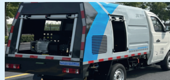
▲ 新能源纯电动路面养护车
