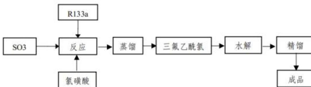
R133a 和三氧化硫进入反应釜进行反应，反应产物三氟乙酰氯，通过水解、精馏得到三氟乙酸。
