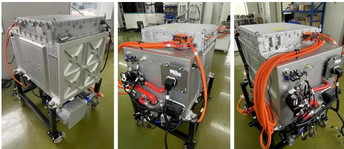
公司自主研发的新一代 235kW 功率的氢燃料电池系统已完成测试并可正式投产，公司最新研发的 300kW 电堆产品采用低铂、高性能膜电极、高耐久超薄双极板，高性能电堆设计与水管理技术，可以满足多场景下动力系统的应用需求。
