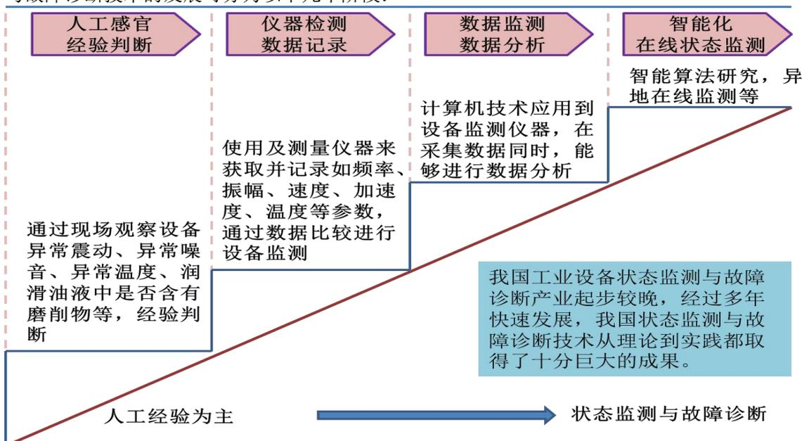
第一阶段：依靠现场获取设备运行时的感观状态，如异常振动、异常噪音、异常温度、润滑油液中是否含有磨削物等，并凭经验或多位专家进行分析研究确定可能存在何种故障或故障隐患。
