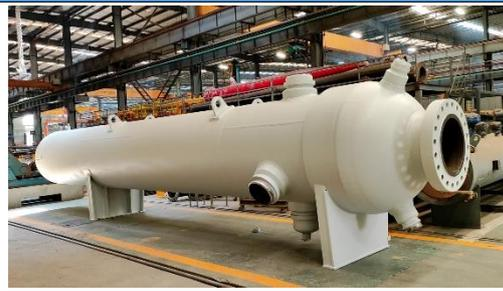
燃气轮机配套前置模块高性能换热器
