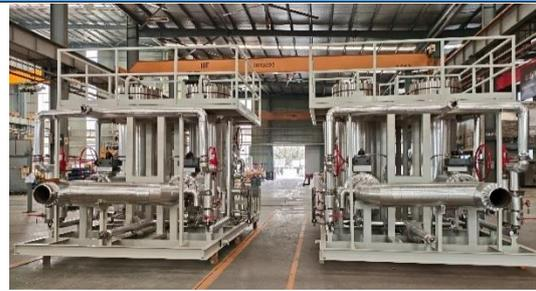
燃气轮机配套前置模块过滤橇
