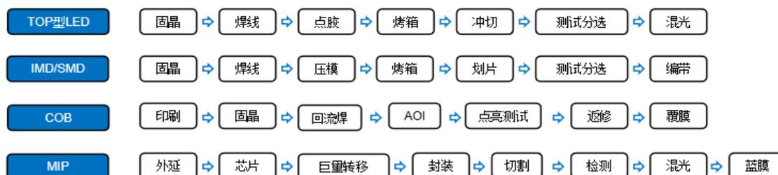
产业链经过多年沉淀，通过不断优化 Mini LED 的技术方案，降低量产成本，有助于降低终端产品价格，进而打开市场。降本空间主要来源于 LED 光源、PCB 基板、驱动 IC、辅助材料和生产制造，可通过缩小 LED 芯片尺寸、提升点测分选效率、芯片降价等方式降低成本。因此升级封装工艺段设备的性能和保证封装良率属于行业降本的重要环节之一。行业中，特别是 Mini/Micro LED 显示器件的封装过程中，固晶设备、印刷设备是实现 LED 芯片巨量转移、提升作业速
