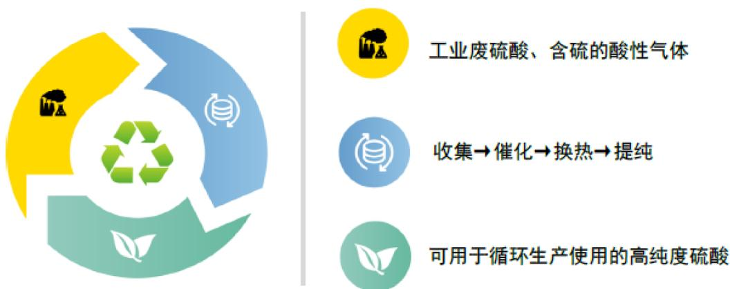
博奥环境目前主要从事设计、生产、销售以工业废酸再生工艺及装备为代表的节能减排环保工艺装备。工业废酸再生工艺及装备通过对客户工业生产过程中的废硫酸、含硫的酸性气体进行收集、处理，生成高纯度硫酸用于循环生产，并释放热能用于回收再利用，实现节能、减排、循环利用、经济、环保的效果，助力实现碳达峰和碳中和减排目标
