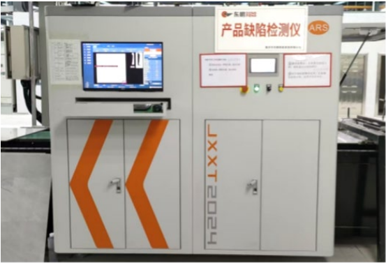
东鹏瓷砖智能缺陷检测设备
