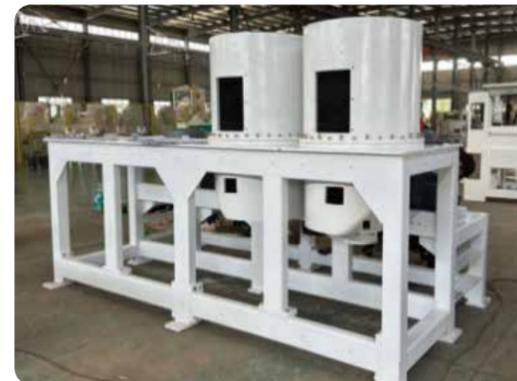
打造全新的破碎脱皮一体化主体结构，优化材质和结构性能，提升设备强度和耐用性。
