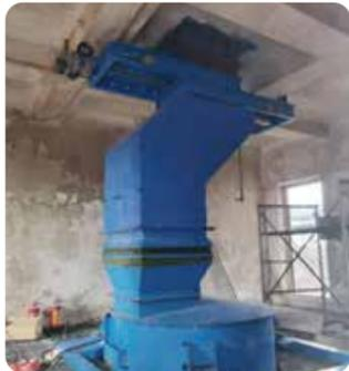
实施粮物流多式联运高效衔接装备研发，粮食抑尘接收发放装置已在广州白云良田库、黄埔项目、深汕项目、江西樟树库项目投入使用，确保发放量准确性的同时控制粉尘。
