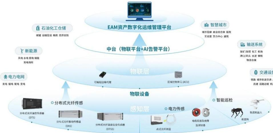
其中，分布式光纤传感是一种新型的前沿传感技术，以光波导原理为基础，以光纤为媒介，实现对温度、应变、位移、振动、电流等物理参量的测量和感知，光纤既作为传感元件同时又作为通信元件。分布式光纤传感具有距离长、精度高、本征安全、鲁棒性强、易于大规模组网、沿途无需供电等优点。
