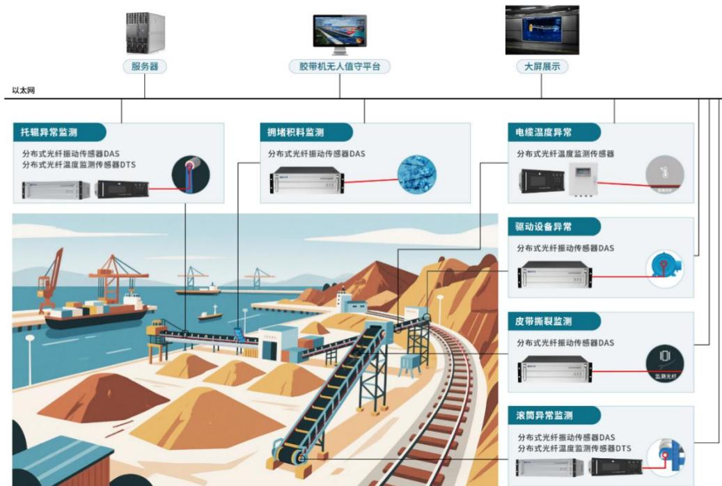
以上产品主要由公司自主研发的分布式光纤传感器、边缘计算网关、智能终端和资产数字化运维管理软件平台等硬件设备和软件系统构成，是典型的 AIOT (AI+IOT) 架构，具体的架构如下：
