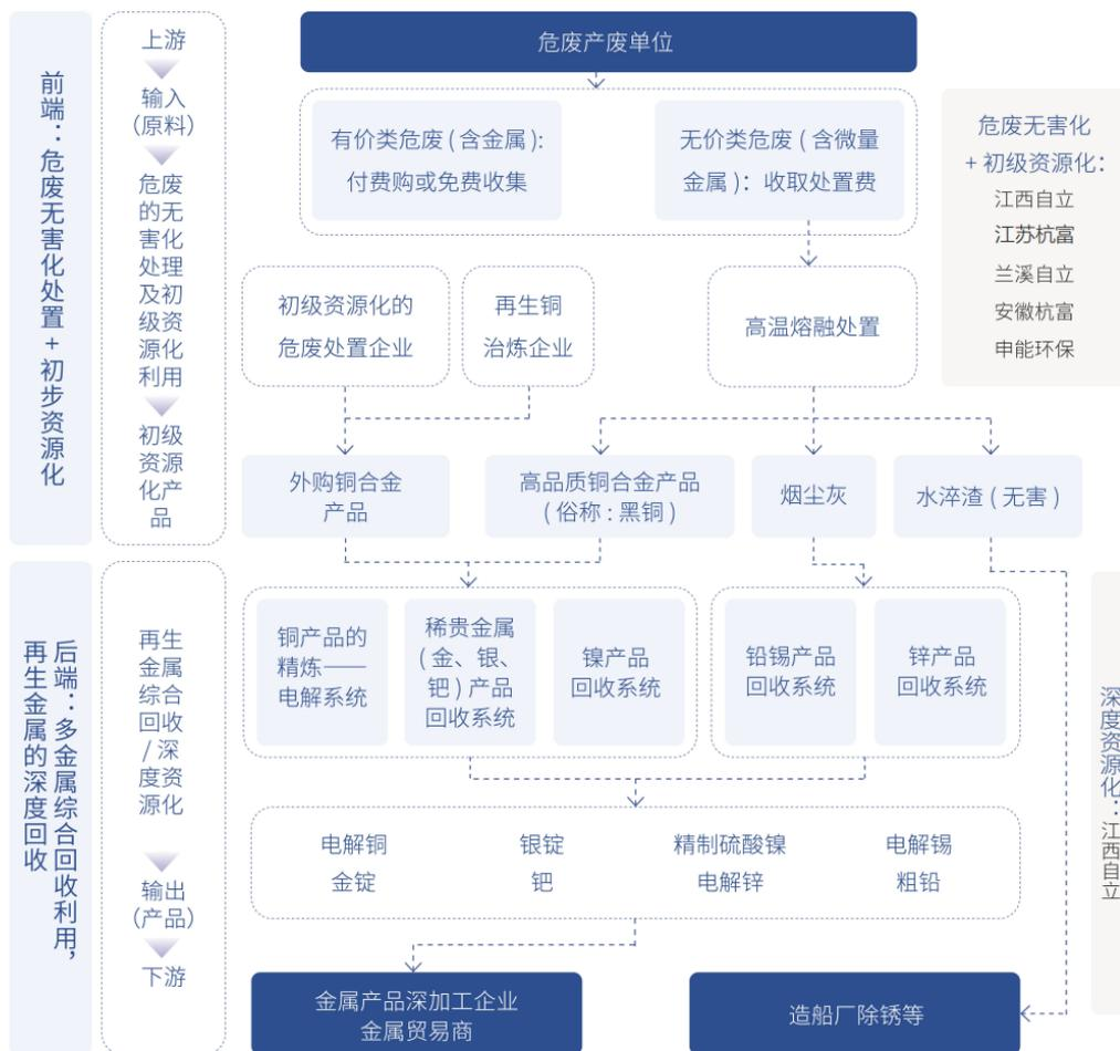
相较于常规的填埋、焚烧、水泥窑协同等第二代无害化处置技术，公司产业链前端使用的高温熔融无害化处置技术属于目前市面上最新的第三代无害化处置技术，处置物料范围广，偏好包含重金属的物料，且可处置焚烧底渣及烟尘灰，可彻底将危险废物无害化，实现了危险废物的无害化处理及资源高效回收，真正做到“消除危害、变废为宝”；同时公司采用一体化、规模化发展模式，针对不同类别的危险废物，采用不同技术和工艺进行无害化处理并实现资源化利用，实现了各类危废及一般固废的“量体裁衣、吃干榨净”，有效降低了危废处理的综合成本，提升了环境效益和整体经济效益。
