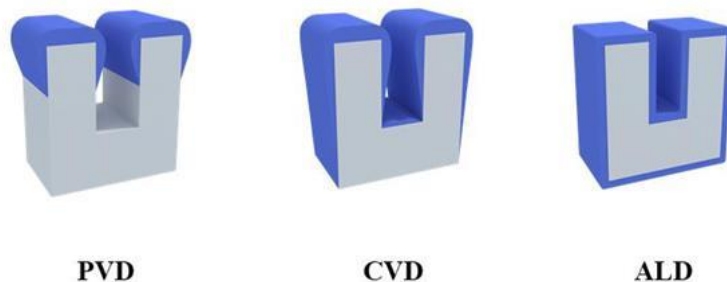
PVD、CVD、ALD 薄膜沉积效果示意图
