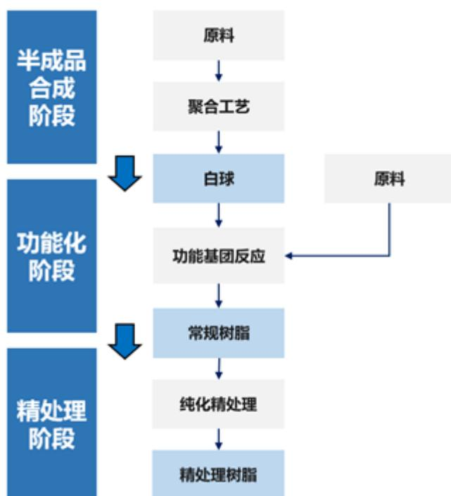
因公司产品规格型号较多，不同型号加工工艺不完全相同，阴离子树脂与阳离子树脂、凝胶型树脂与大孔型树脂、精处理树脂与常规树脂的原材料及生产工艺亦存在较大差异，主要工艺流程为以下几个环节：
