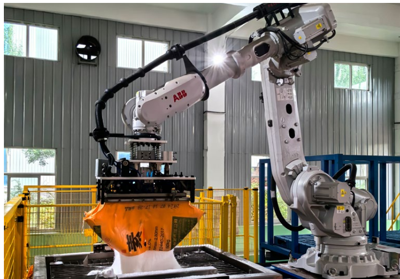
✧ 尿素投料机器人实现 SCR 催化剂物料的智控流转
