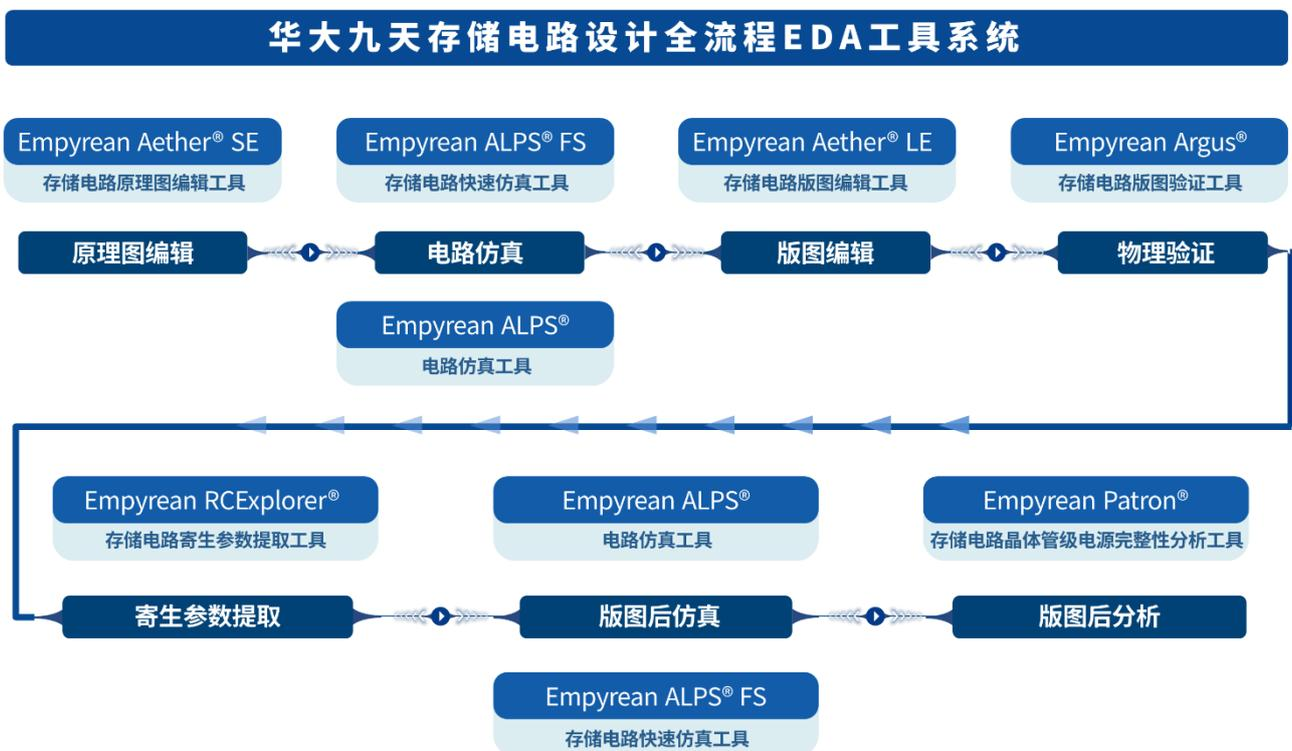
公司存储电路全定制设计全流程 EDA 工具系统，主要服务于集成电路领域的存储器设计及制造企业，以及系统级芯片设计企业中的存储模块设计团队。针对存储电路设计，该系统支持包括但不限于静态随机存取存储器 (SRAM)、动态随机存取存储器 (DRAM) 以及闪速存储器 (Flash)、磁随机存取存储器 (MRAM)
