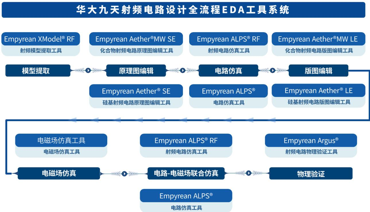
公司射频电路设计全流程 EDA 工具系统主要客户群体为射频集成电路设计企业，包括从事射频芯片和模组设计的企业，主要用于射频芯片与模组的设计和验证。射频集成电路主要用于无线信号的发射与接收，包括功率放大器、低噪声放大器、滤波器、开关、混频器、振荡器、衰减器等不同种类的芯片及多个芯片构成的模组，可广泛应用于智能手机、智能驾驶、5G 通信等领域。
