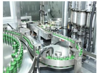
2024 年研发投产的 LR03 高速碱性电池生产线采用双机并排布局、外观简洁、自动化程度高，电池生产速度达到每分钟 1300 只，较普通每分钟 600 个的产线，产量提升了 2 倍。该线多个应用场景获得了工信部及四部委“智能制造优秀场景”等荣誉。
